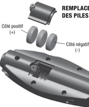
1. Desserrez la vis, enlevez les piles (la vis imperdable reste dans le boîtier).
