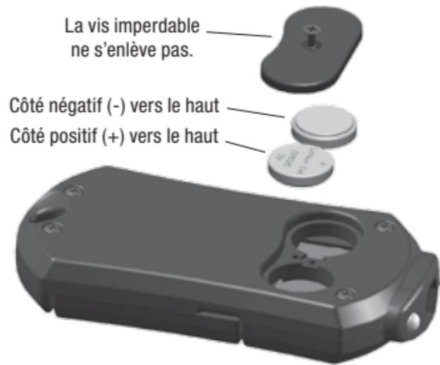
1. Desserrez la vis, enlevez les piles (la vis imperdable reste dans le boîtier).
